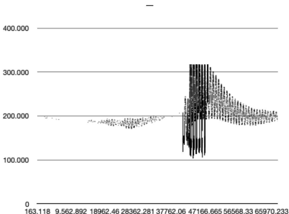
Dal grafico possiamo notare che i valori della posizione oscillano con un'ampiezza maggiore dopo i 10'000 secondi, probabilmente perché l'armadio in cui era chiusa la bilancia veniva irradiato dai raggi del sole, creando correnti d'aria che impedivano una normale oscillazione. Abbiamo stabilito di prendere in considerazione solamente i primi 5000 valori dopo la mezzanotte, quando l'oscillazione non è disturbata da agenti esterni.
